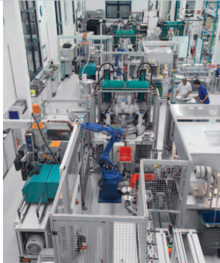
Línea de producción completamente automatizada, que incluye operaciones de estampado, doblado y moldeo por inyección.
